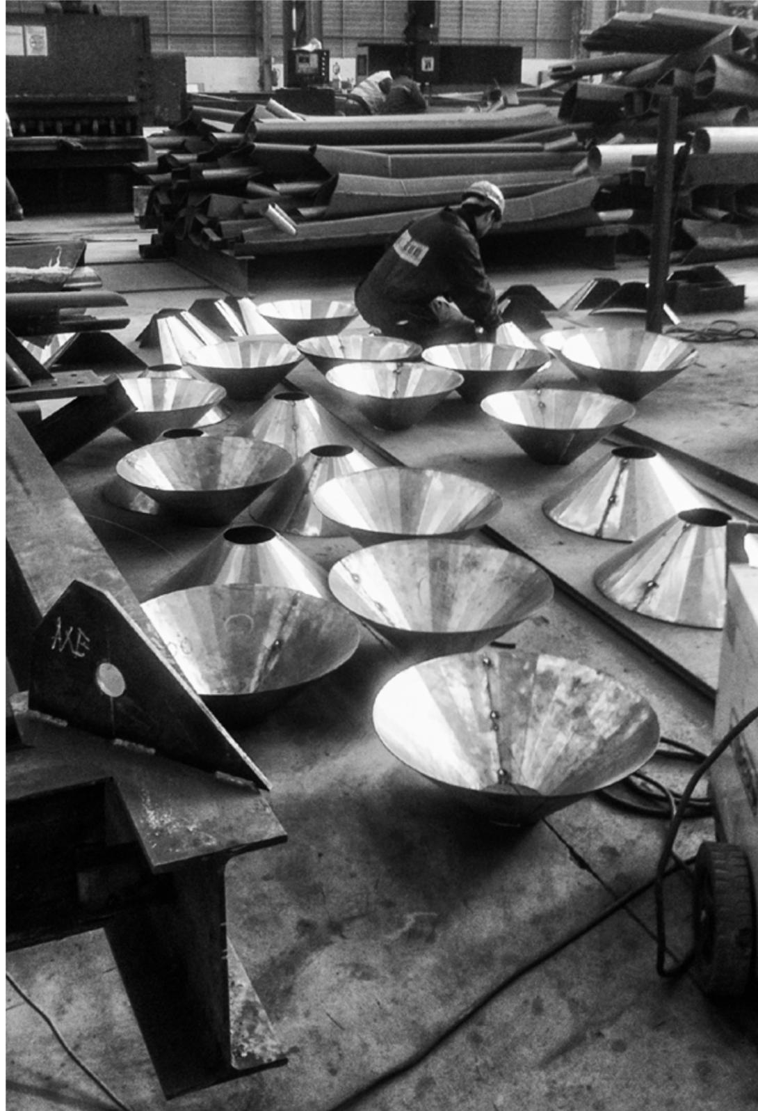
Entonnoirs inox pour récupérer les eaux pluviales à l'intérieur des corolles en tête de poteau.
