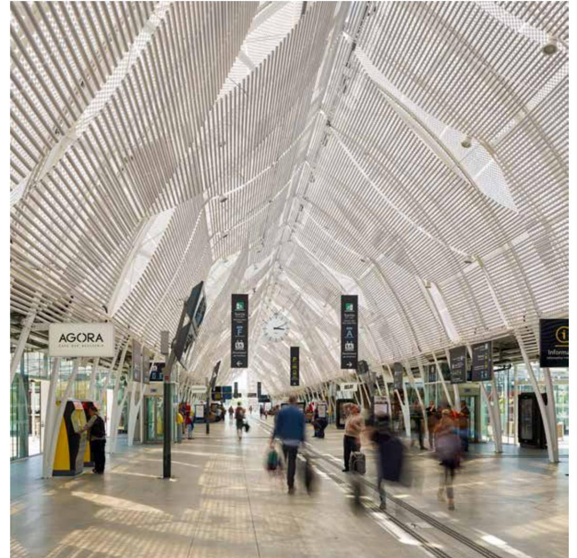
Vue de la Nef complète avec les canisses suspendues. Ces canisses faites de cylindres de mousse filtrent une deuxième fois la lumière, et absorbent les sons qui rebondissent sur les membranes de l'ETFE.
