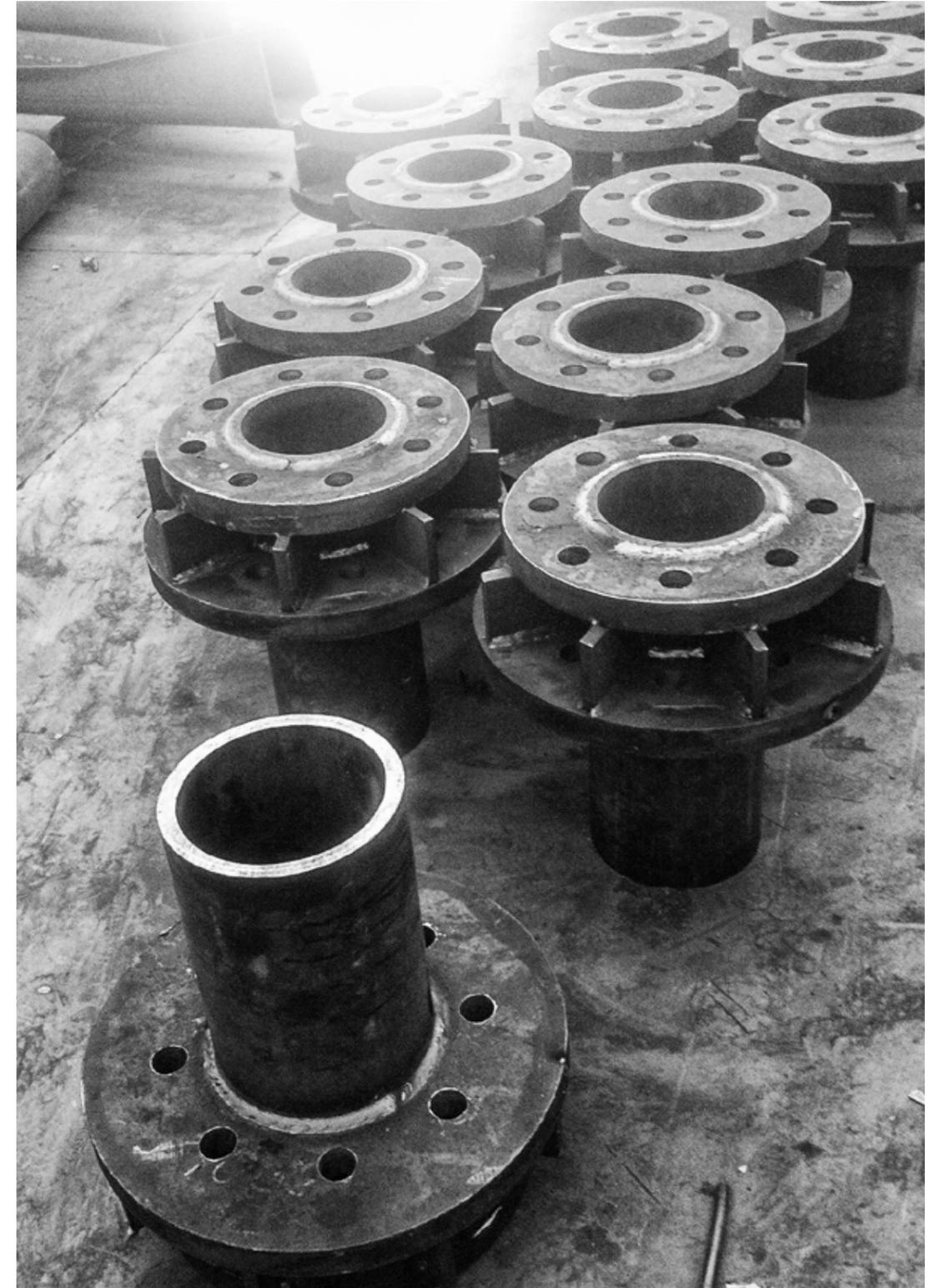
Des doubles platines permettent de boulonner les têtes des tiges d'ancrage sortant des fûts béton. Le poteau tronconique est ensuite soudé sur ces doubles platines, grâce à des ailettes affleurant de la coque. Les têtes des tiges d'ancrage sont ensuite dans un mortier pour être protégées contre d'éventuelles fuites à l'intérieur du poteau. Des trous sont laissés en pied de poteau pour alerter en cas de fuite d'eau.
