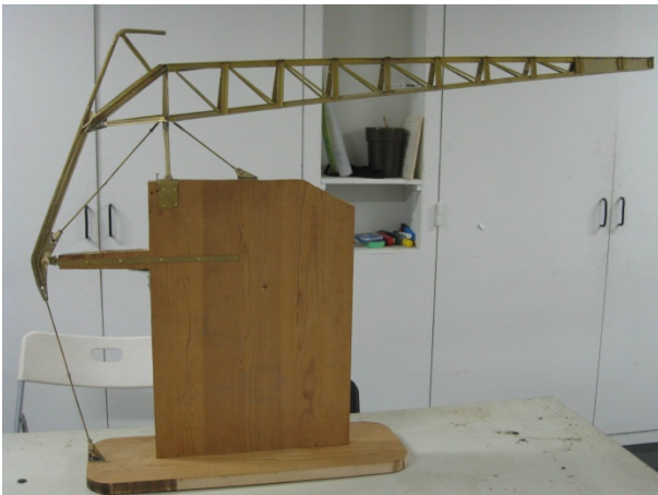
Zone Nord - Maquette d'étude réglable expliquant le fonctionnement de la stabilité au renversement et une descente de charge dans la structure béton limitée à des efforts axiaux.
