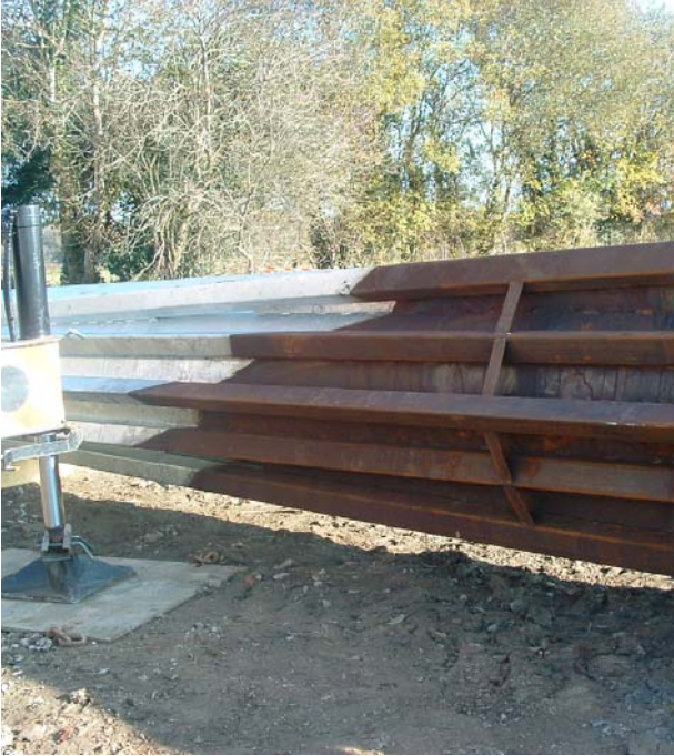
Limite de galvanisation naturellement obtenue par la trempe partielle de la pièce
