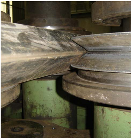
galet usiné sur mesure pour cintrage des membrures en tôle pliée
