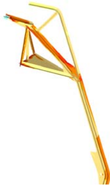
partie arrière support de poutre en porte à faux - début de montage – calculs Exe et modèle 3d MaP3
